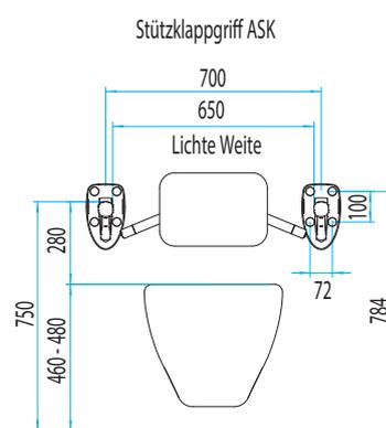
Bei Verwendung von Vorwandinstallationssystemen überprüfen Sie bitte, ob das von Ihnen gewählte System die Montage nach den Vorgaben der Abbildung ermöglicht.
