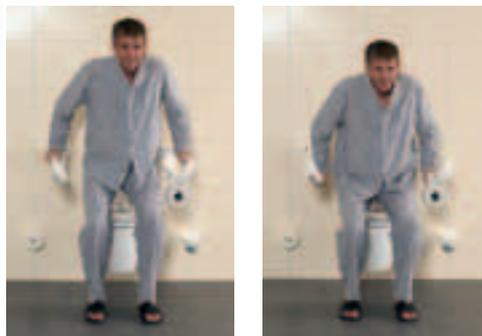
Durch die Schrägstellung der Griffholme gibt es zwei Griffhöhen in einem Griff. Der obere Griffholm unterstützt beim Setzen, der untere beim Aufstehen. So wird die Eigenständigkeit des Nutzers gefördert und weniger Unterstützung durch Pflegepersonal ist notwendig.
